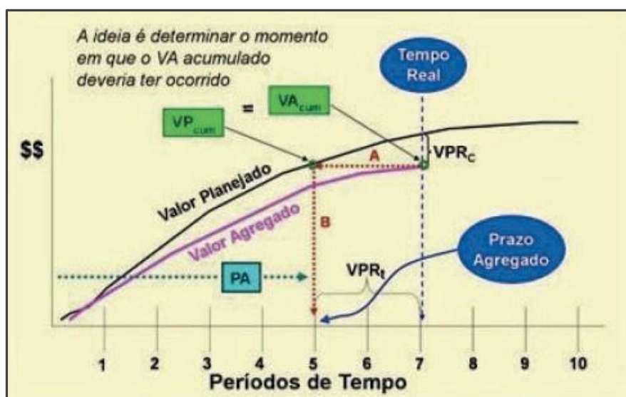
Figura 7 - Conceito de Prazo Agregado (PA). Fonte: W. Lipke, 2009
