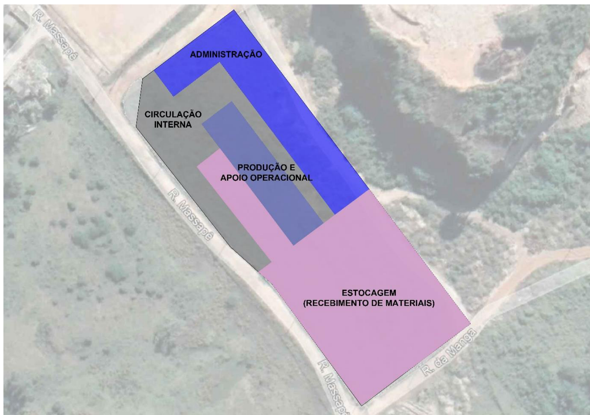
Figura 6 – Planta de setorização do canteiro de obras
