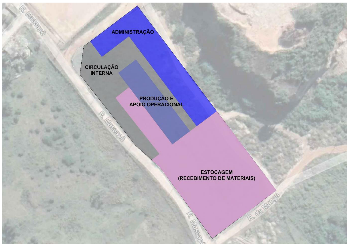
Figura 6 – Planta de setorização do canteiro de obras
